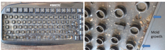
ปัญหาเชื้อราจากเพิ่มอัตราการระบายอากาศจนอาคารมีสภาวะ Negative Pressure แรงดัน (-) อันเป็นเหตุให้เกิด “เชื้อราเจริญเติบโตกระจายทั่วอาคาร”
