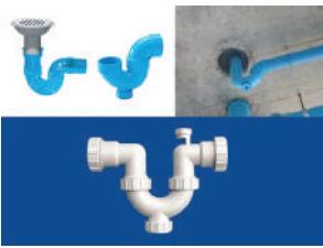
แสดง U-Trap ของ floor drain เพื่อชิงน้ำป้องกันกลิ่นไหลย้อน แต่ต้องคอยระวังไม่ให้น้ำที่ขังไว้แห้ง
